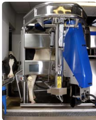
DeLaval VMS (Voluntary Milking System) är ett helautomatiskt mjölkningssystem där kon själv bestämmer när hon vill bli mjölkad. En VMS-anläggning består av en eller flera mjölkningsstationer som vardera mjölkar upp till 60 kor, två till tre gånger per dygn.
