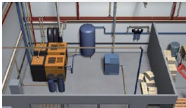
En konventionell kompressor, med extern filtreringsutrustning och hög ljudnivå, måste placeras på avstånd från produktionsområdet. Den typen av bristande integrering kan orsaka högre installationskostnader.
